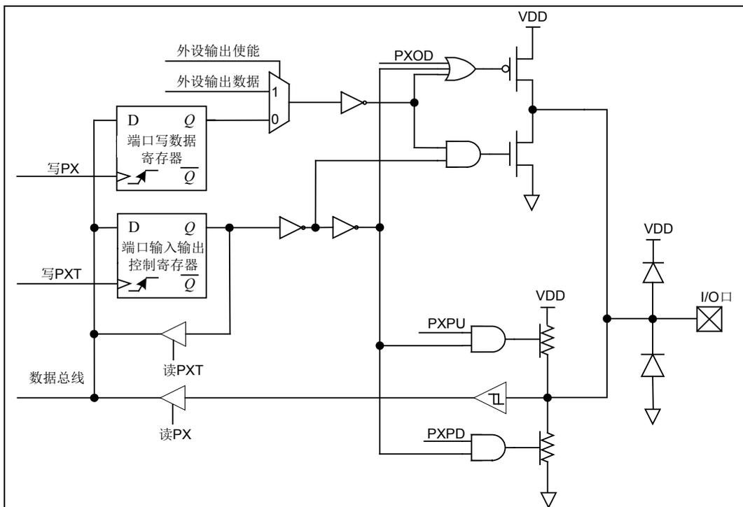
图 4-2 PC 端口结构图
