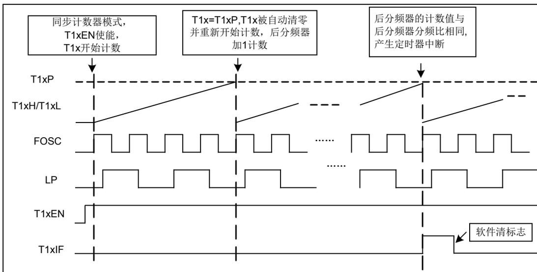
图 6-6 T1x 同步计数模式时序图
