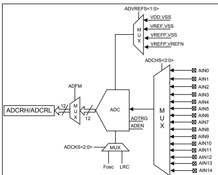
图 6-37 ADC 内部结构图
