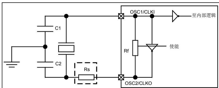
图 5-2 晶体/陶瓷振荡器电路示意图
