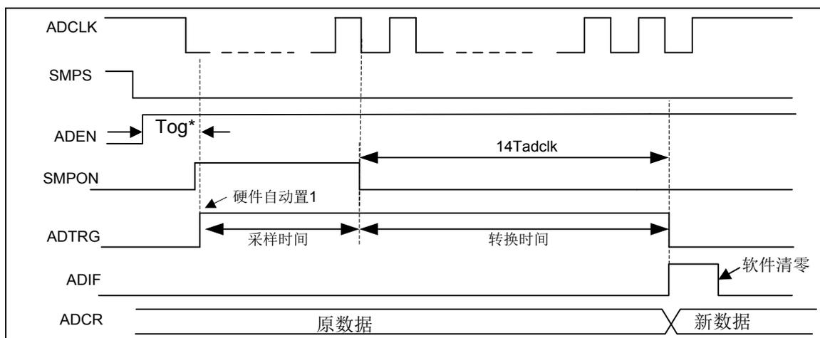
图 6-38 ADC 时序特征示意图 (SMPS=0)
