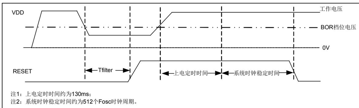
图 5-6 低电压复位时序示意图
