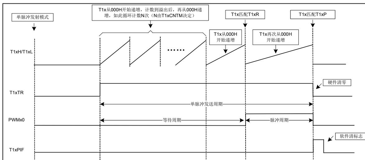
图 6-9 T1x 单脉冲发射模式示意图
