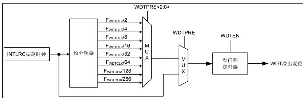
图 5-3 看门狗定时器内部结构图
