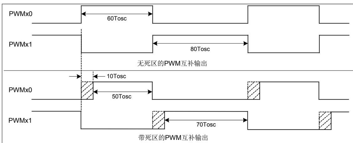
图 6-11 PWM 死区时间示意图（死区时间 10Tosc）
