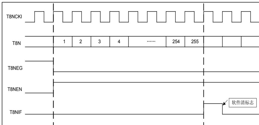
图 6-3 计数器模式时序图 (T8NEG=0, T8NCKI 上升沿计数)
