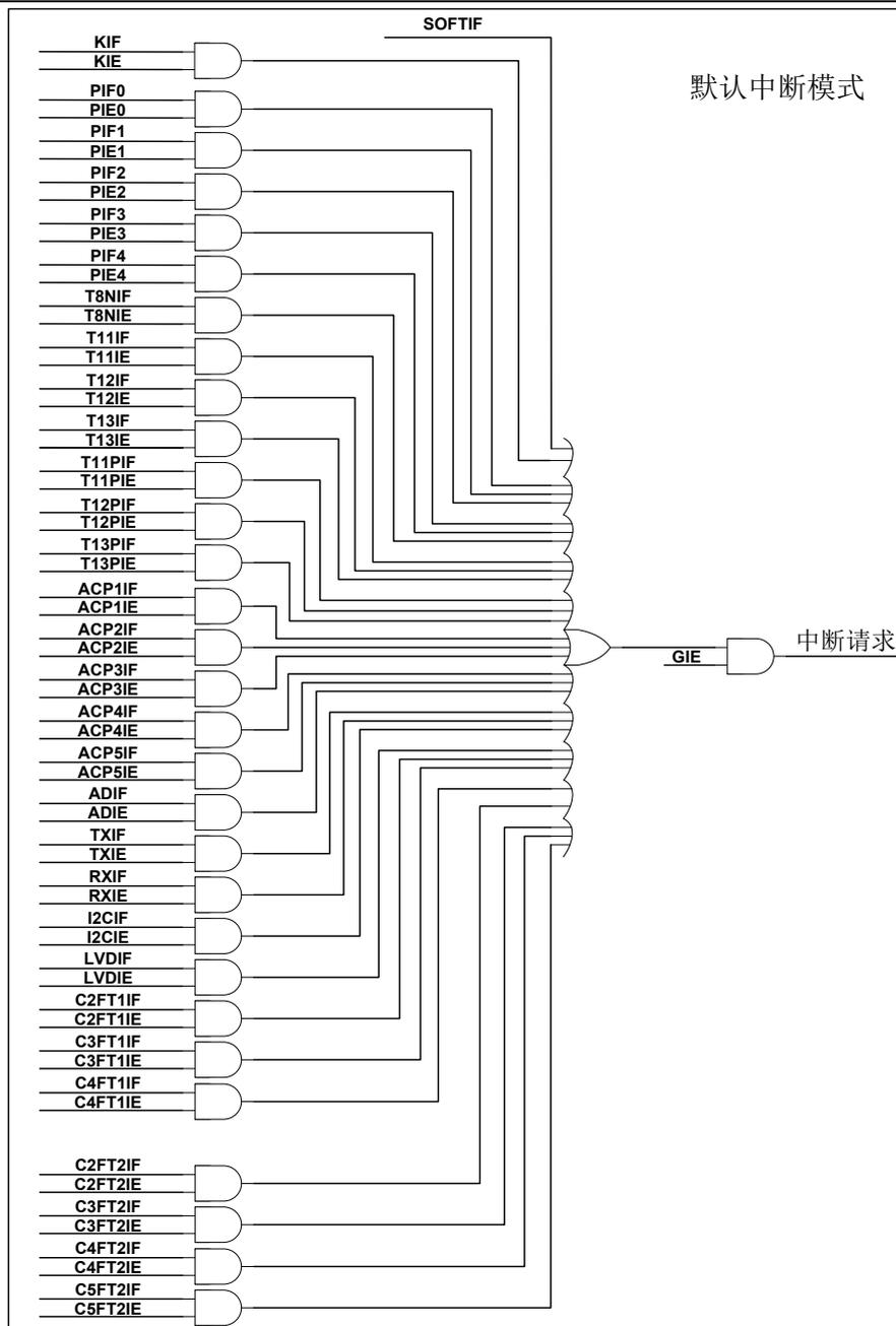
图 7-1 默认中断模式中中断控制逻辑
