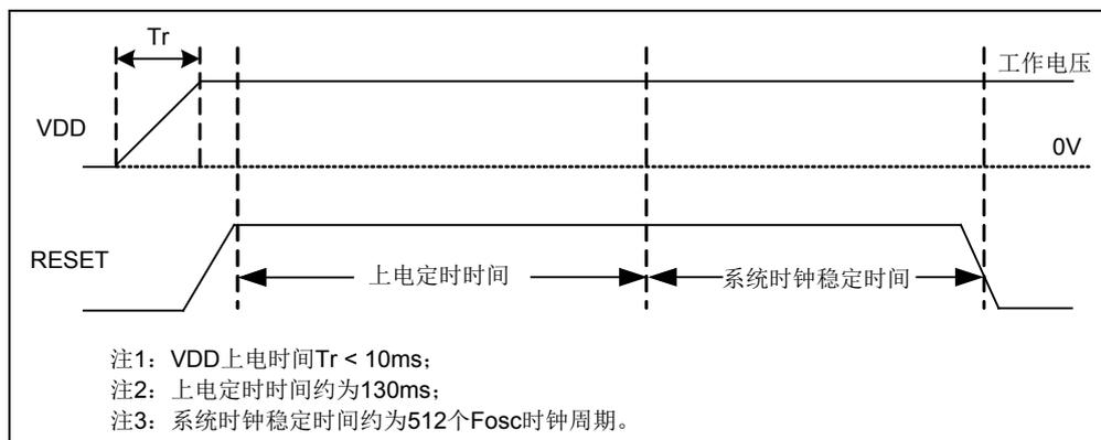
图 5-5 上电复位时序示意图
