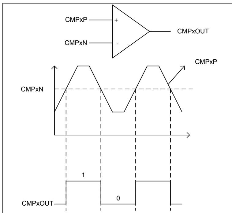
图 6-29 模拟比较器工作示意图
