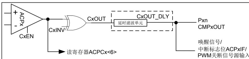
图 6-30 比较器 ACPx 中断产生示意图
