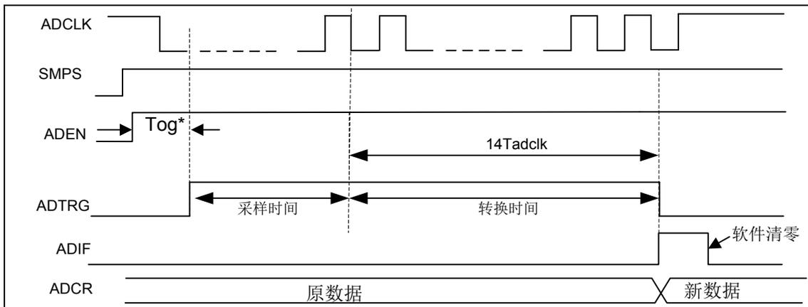
图 6-39 ADC 时序特征示意图 (SMPS=1)
