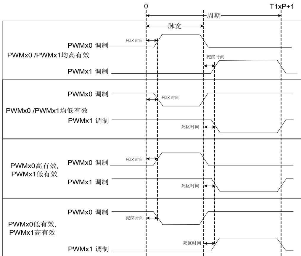
图 6-12 PWM 带死区互补输出极性示意图
