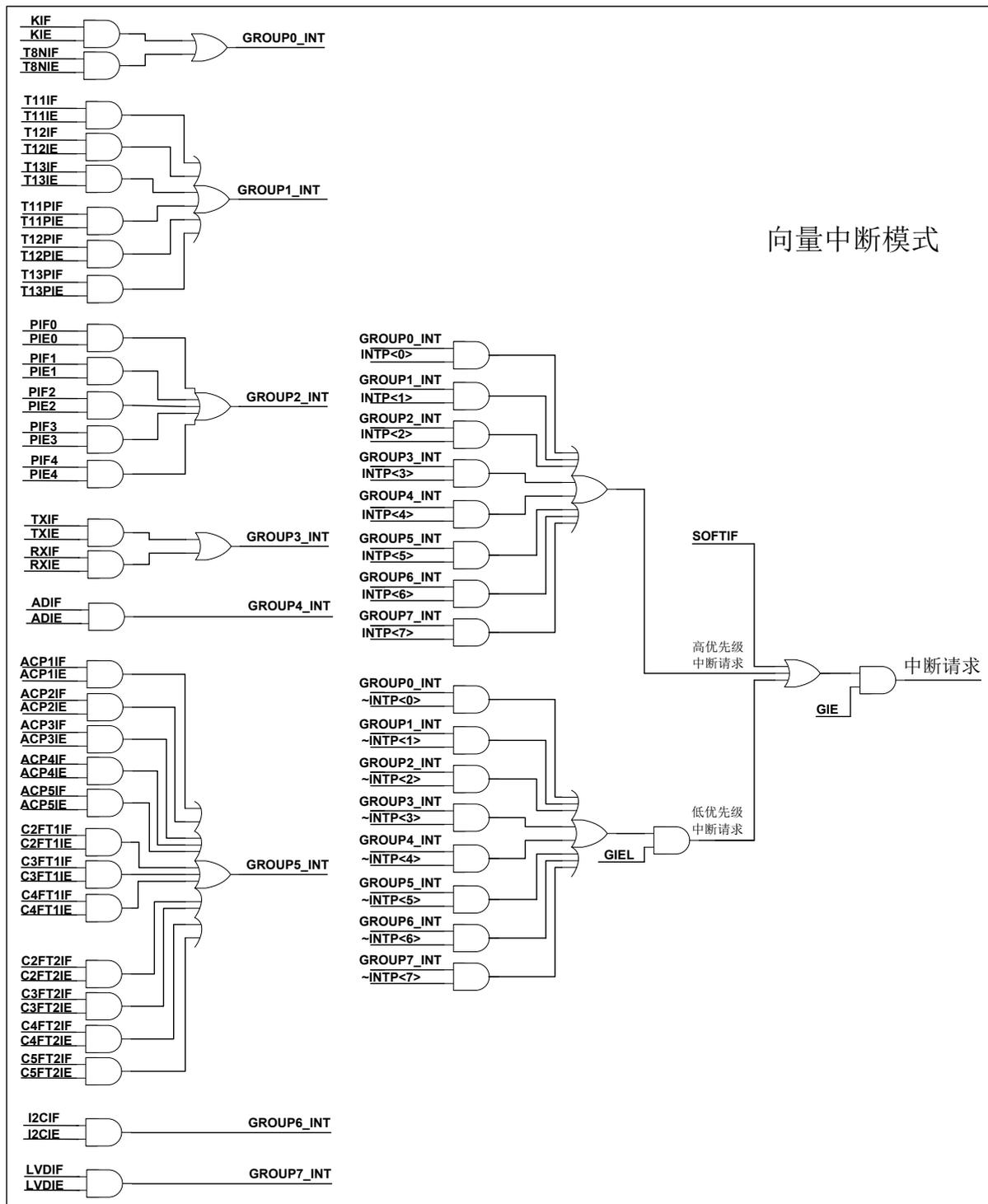
图 7-2 向量中断模式中中断控制逻辑
