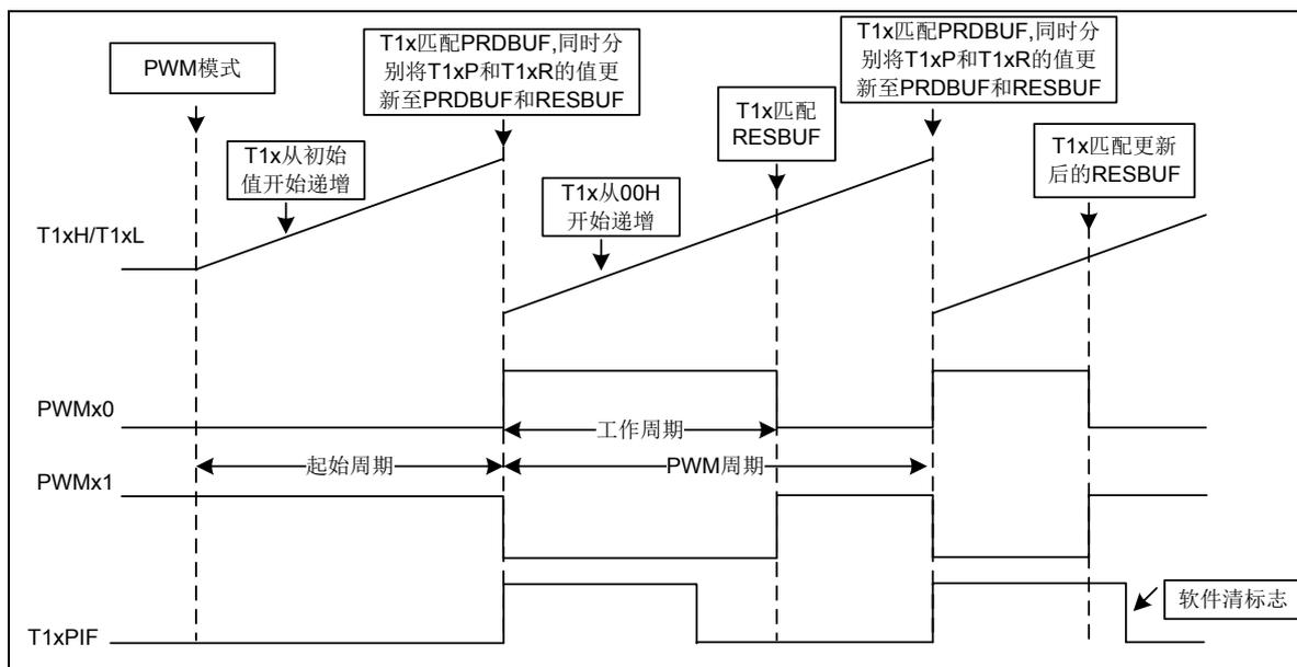
图 6-10 PWM 输出模式示意图
