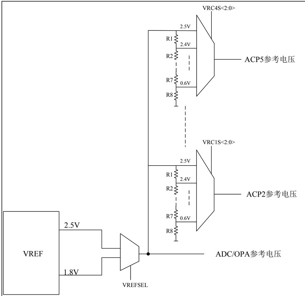
图 6-34 内部参考电压供电示意图
