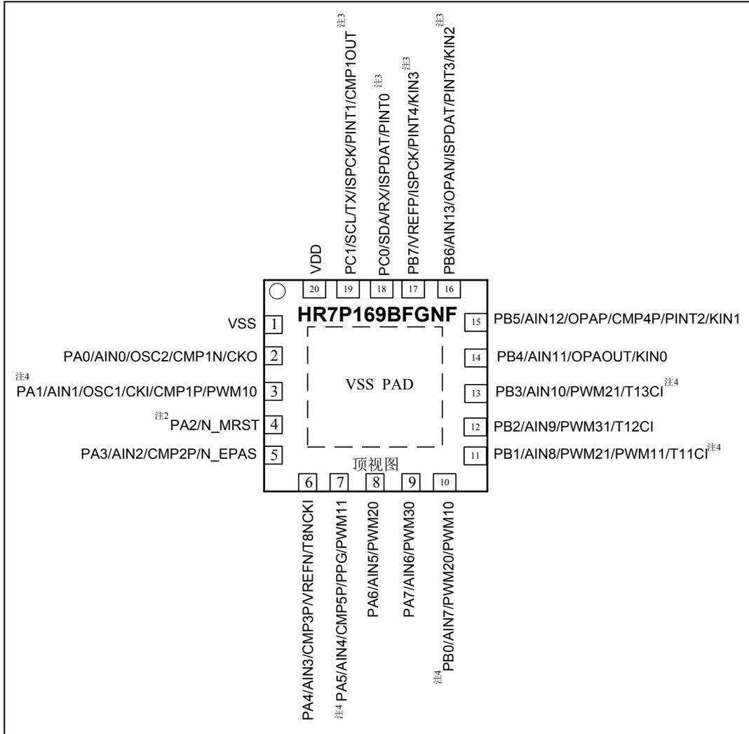
图 1-3 HR7P169B (QFN20) 顶视图
