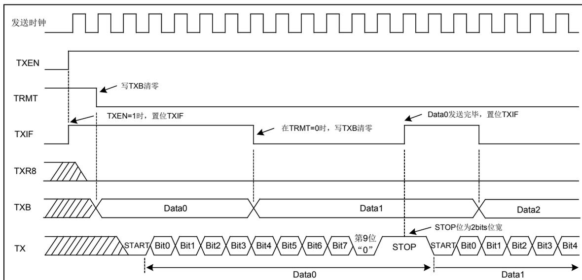
图 6-19 UART 发送器发送数据时序图（9 位数据格式，第 9 位数据为“0”）
