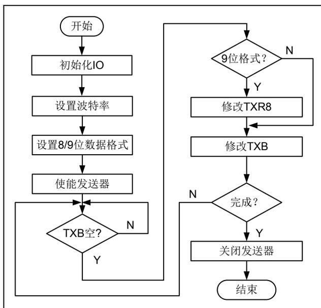
图 6-18 UART 异步发送器操作流程
