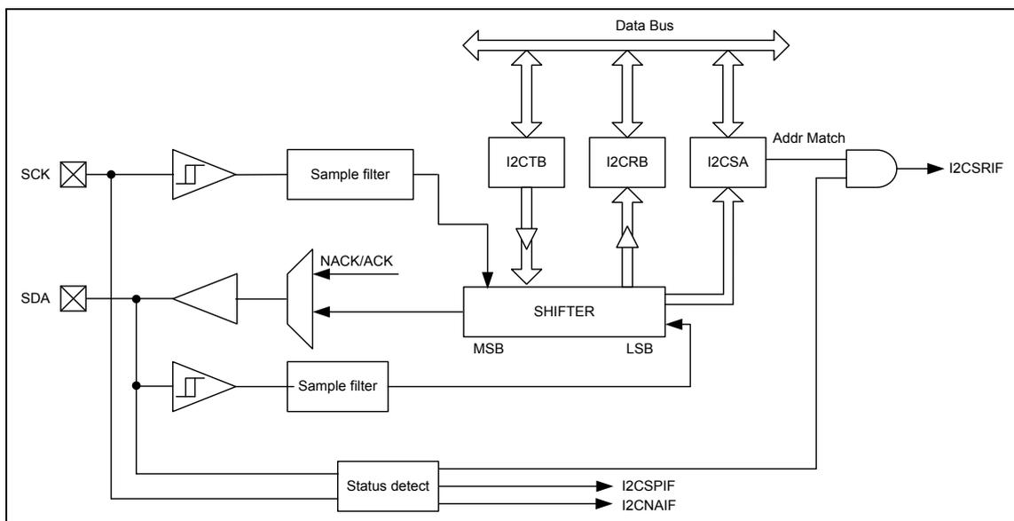
图 6-22 I2C 内部结构
