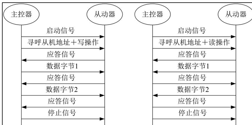
图 6-23 I2C 总线通讯协议示意图
