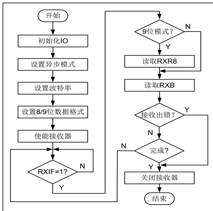
图 6-20 UART 异步接收器操作流程图
