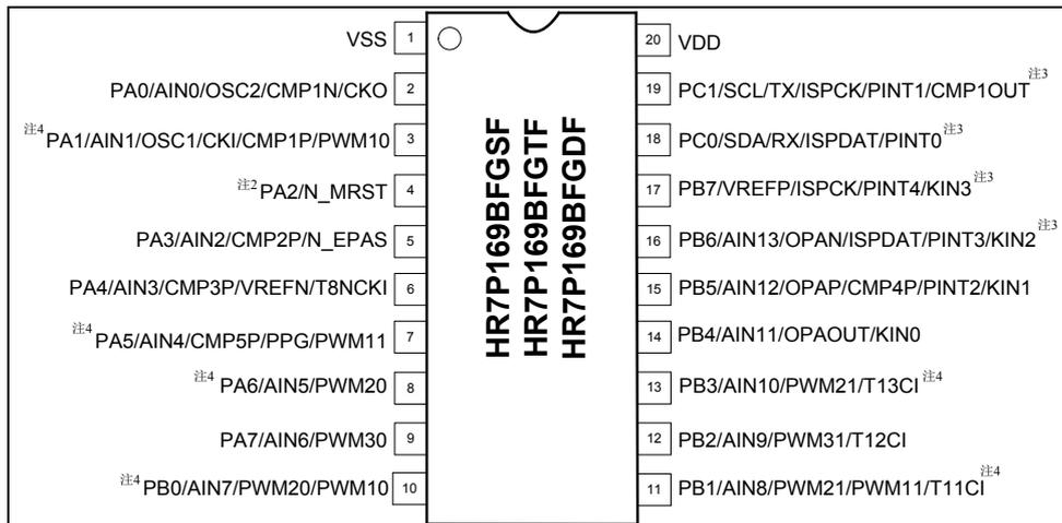
图 1-2 HR7P169B (SOP/TSSOP20/DIP20) 顶视图
