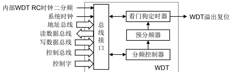
图 6-12 看门狗定时器内部结构图
