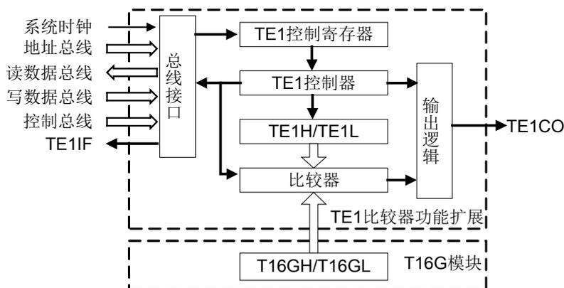
图 5-11 比较扩展功能的内部结构图
