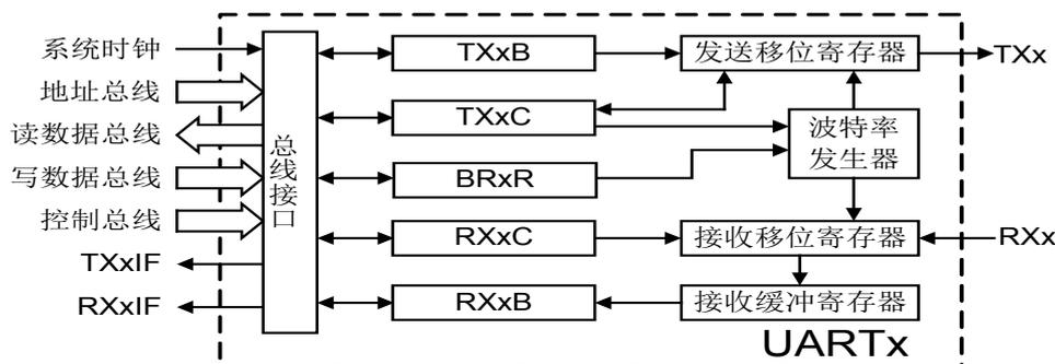
图 5-14 UARTx 内部结构图
