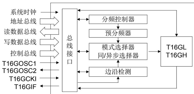
图 5-3 T16G 定时器/计数器内部结构图
