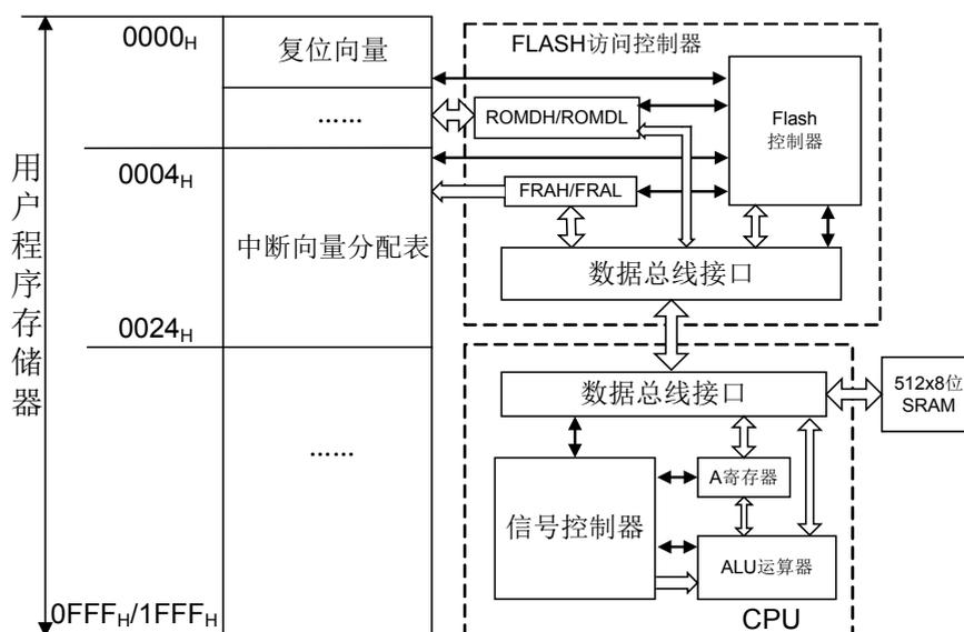
图 3-2 程序存储器查表操作示意图
