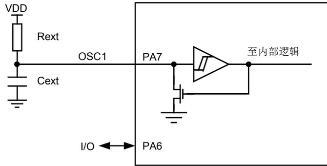
图 6-3 外部 RC 振荡器参考图 1
