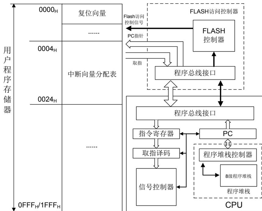
图 3-1 程序指针 PC 直接寻址示意图
