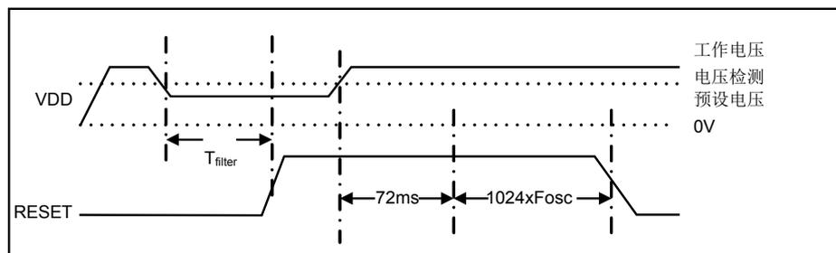
图 6-8 低电压复位时序示意图
