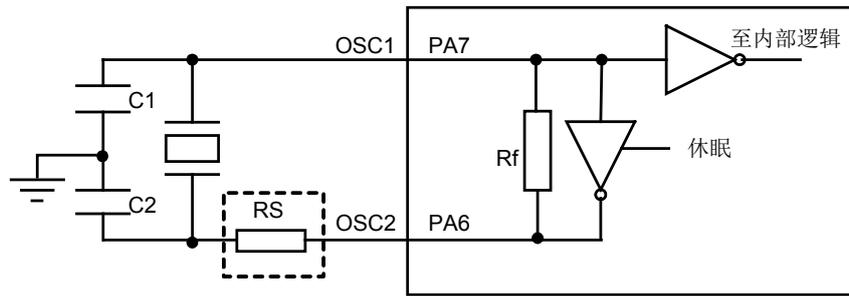
图 6-5 外部 LP/XT/HS 振荡器参考图
