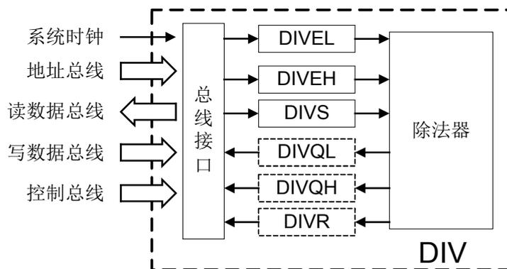
图 2-1 硬件除法器内部结构图
