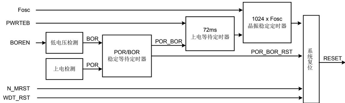
图 6-6 系统复位内部结构图
