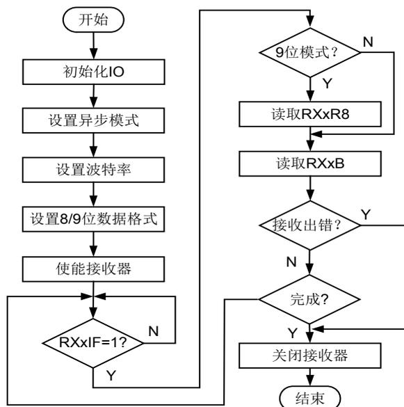
图 5-17 UARTx 接收器操作流程
