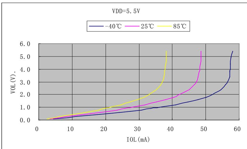
◆ I/O 端口（大电流驱动）信号输出特性图
