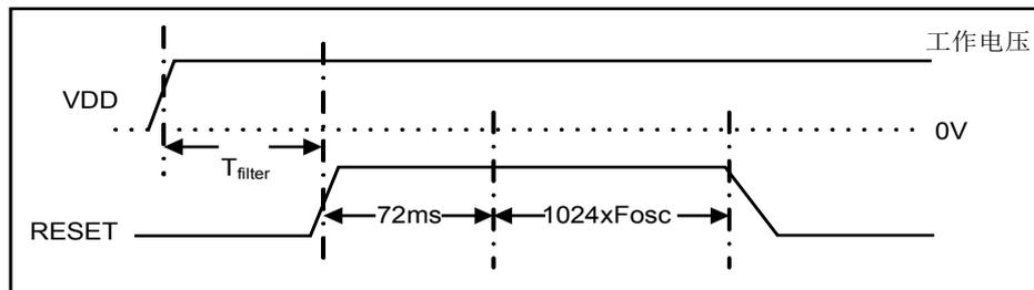
图 6-7 上电复位时序示意图
