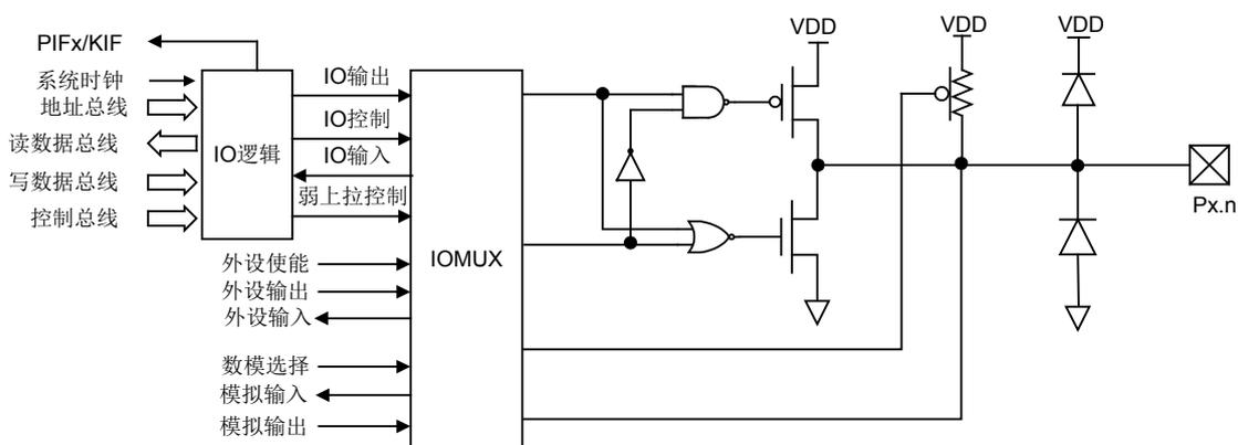
图 4-1 输入/输出端口结构图
