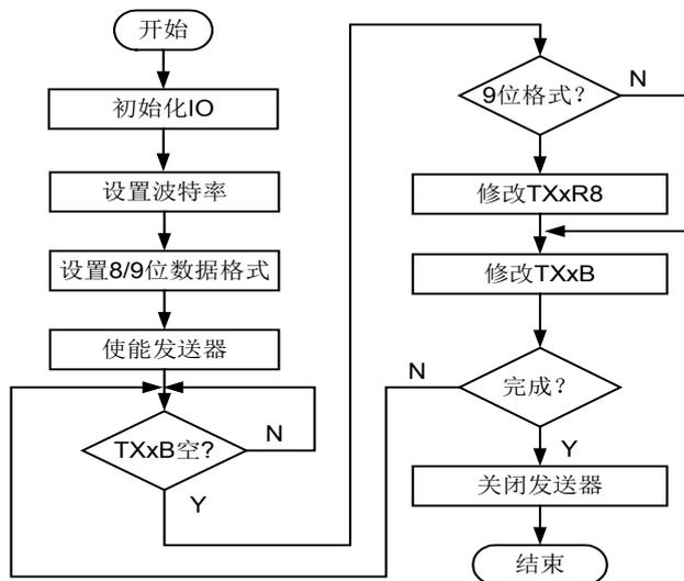
图 5-16 UARTx 发送器操作流程
