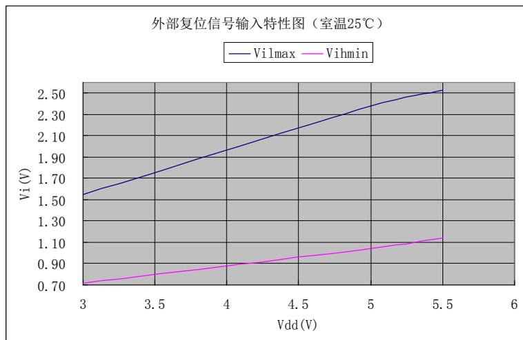
◆ I/O 端口信号输入特性图 (室温 25°C)
