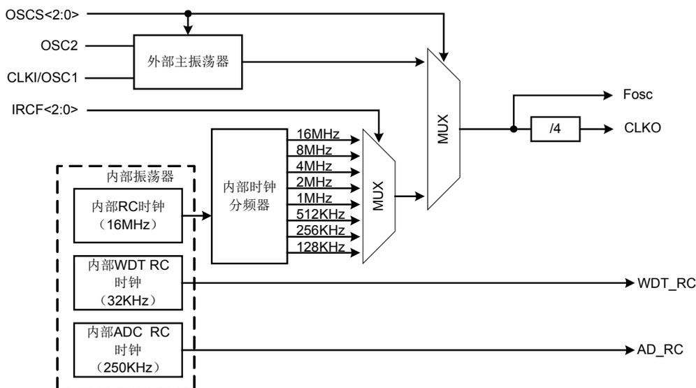
图 6-1 系统时钟内部结构图
