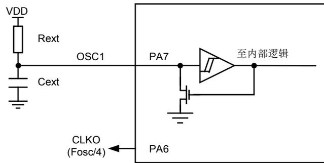
图 6-4 外部 RC 振荡器参考图 2
