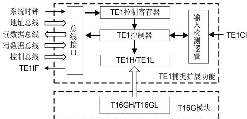
图 5-10 捕捉扩展功能的内部结构图
