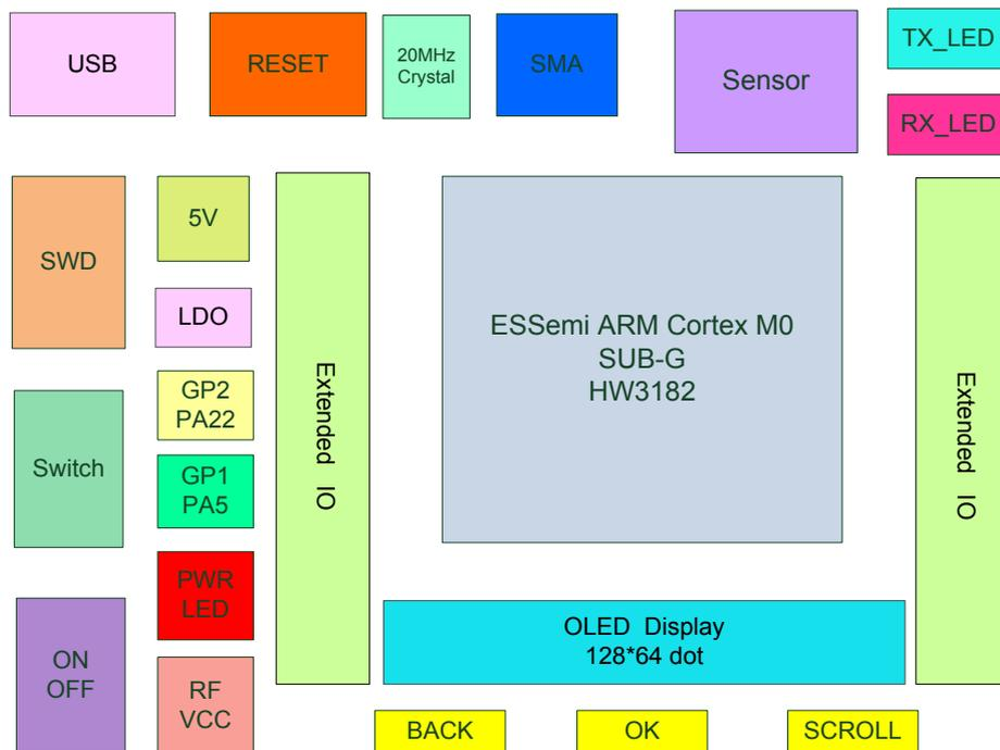
图 2-1 HW3182 SDK 系统结构图
