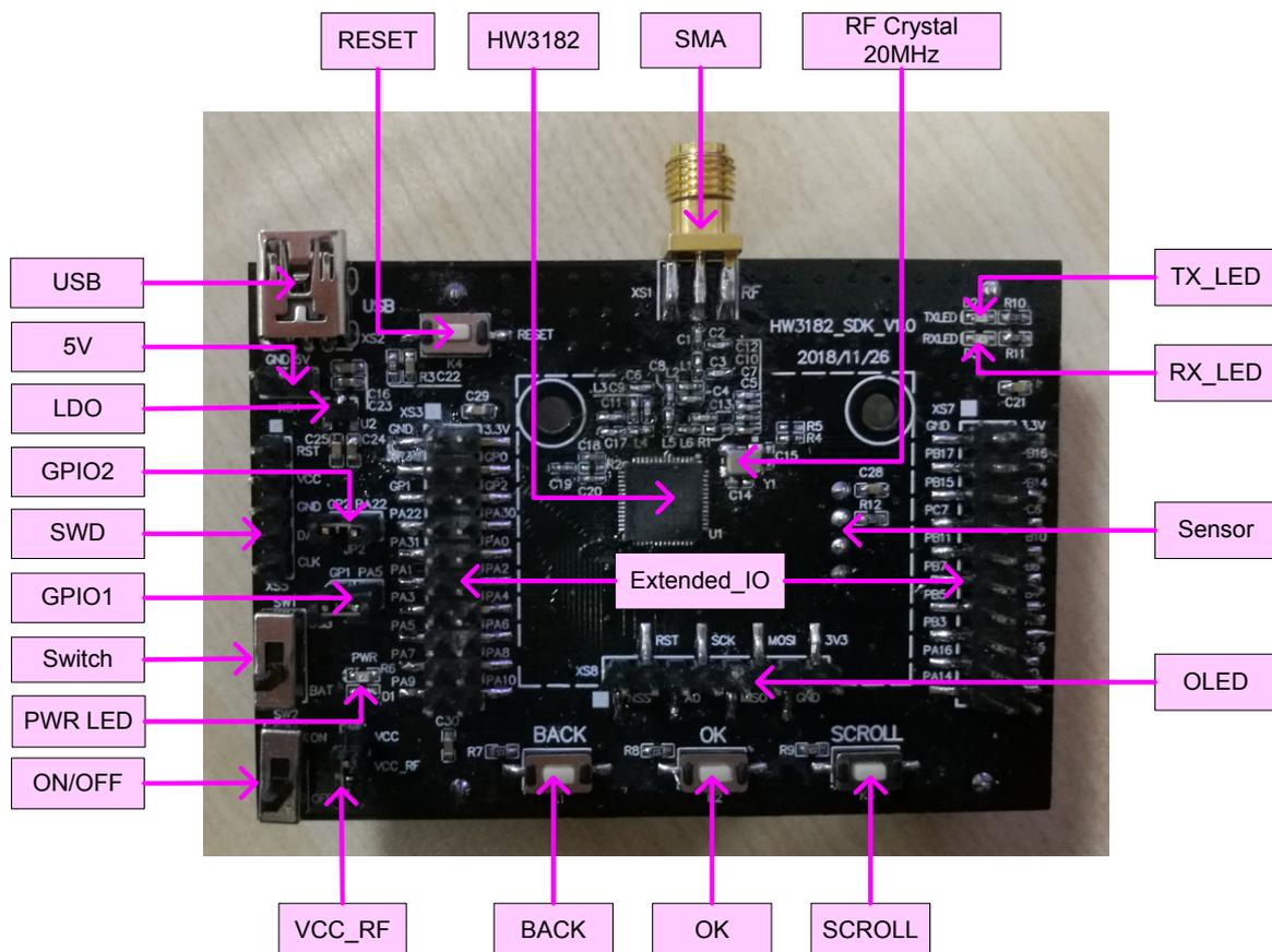
图 2-2 HW3182 开发板硬件示意图
