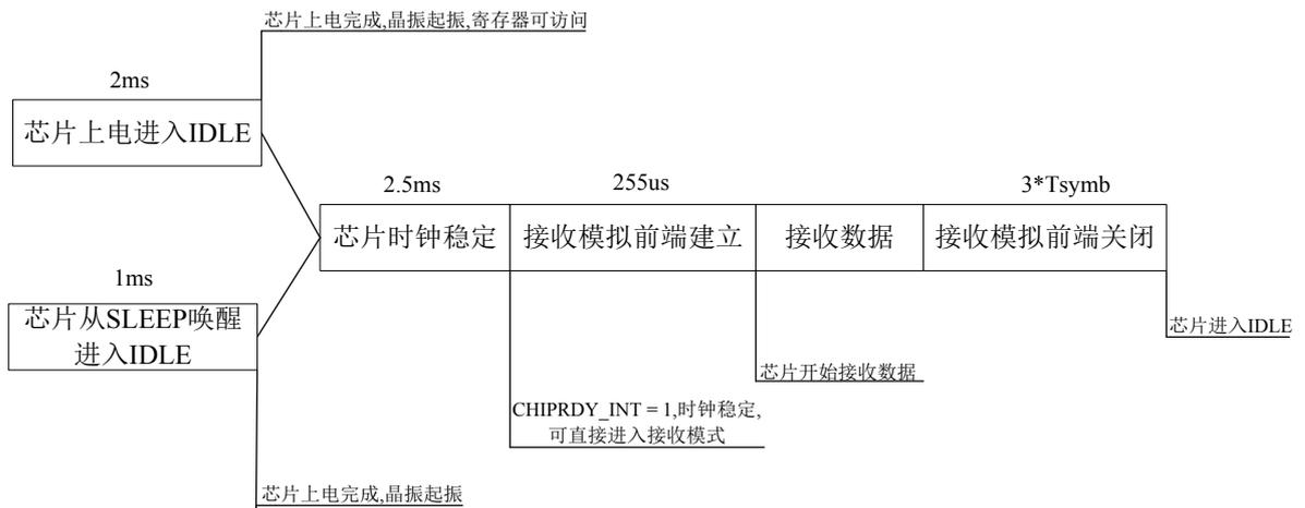
图 6-3 芯片上电进入接收模式示意图
