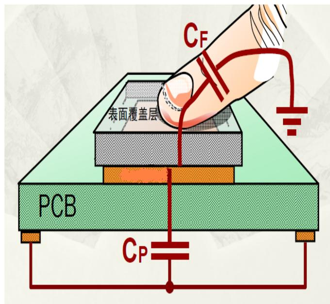
图 1-1 按键电容变化原理
