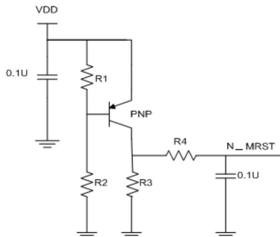
电压检测原理：当 VDD 电压下降，导致 R1 两端电压  $< 0.7\text{V}$  时，PNP 晶体管截止，N\_MRST 引脚被 R3 电阻下拉至低电平，使芯片处于复位状态。
